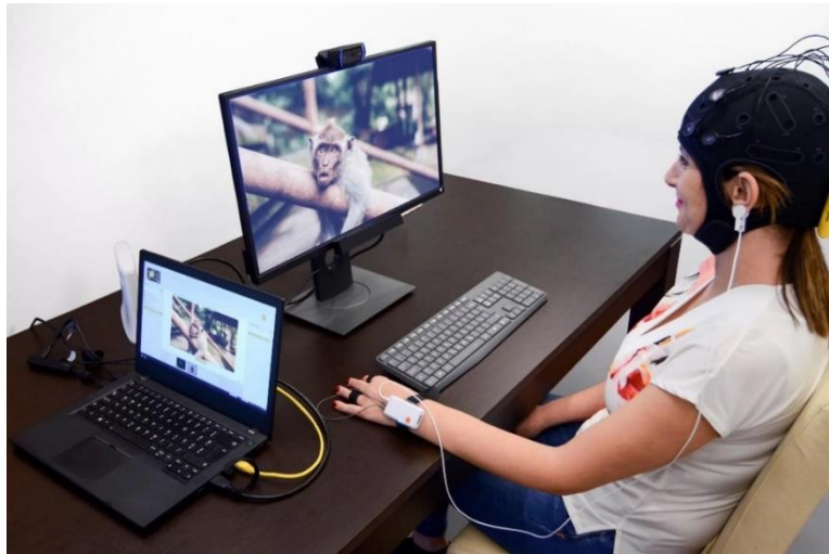
Slika 8. GSR uređaj na ruci u kombinaciji s drugim metodama
